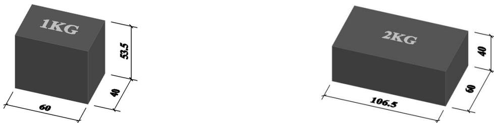
图 4 砝码尺寸示意图（单位：mm）
