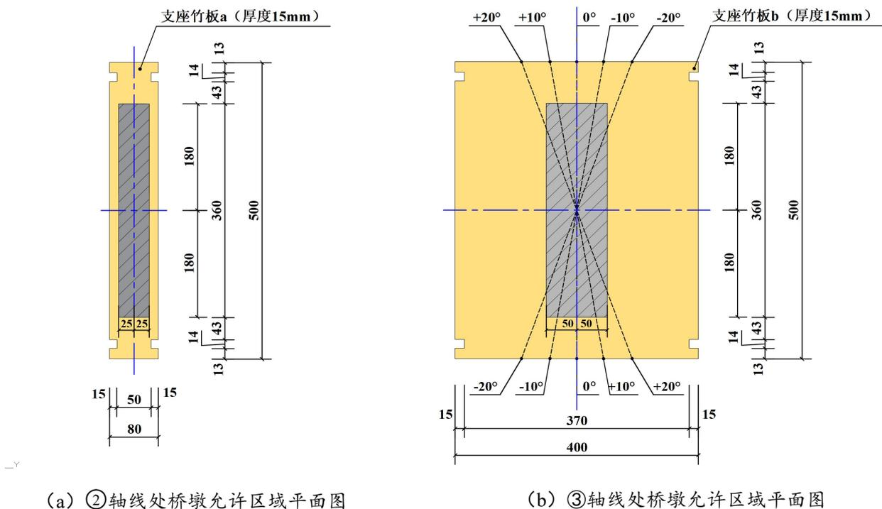
图 3 桥墩允许区域平面图（单位：mm）
