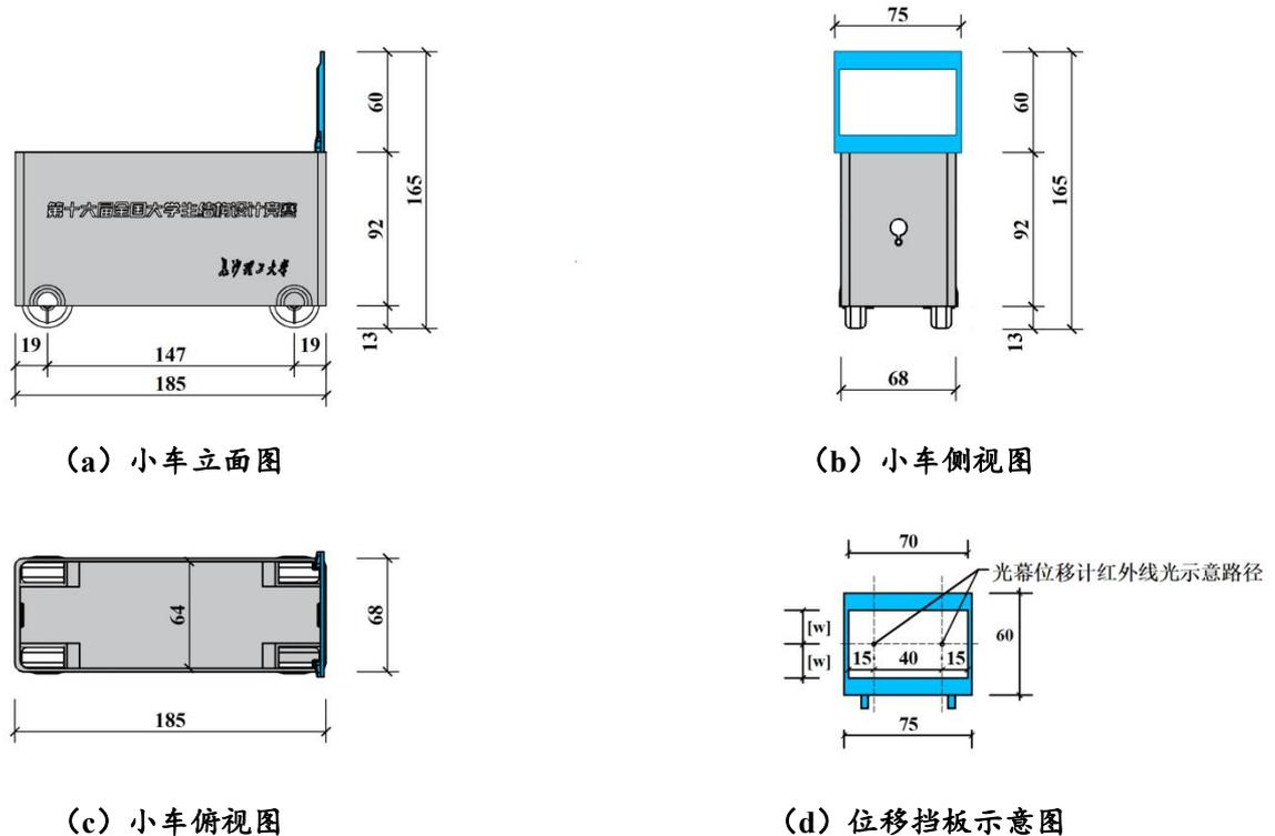
图 8 加载小车详图（含位移挡板）（单位：mm）
