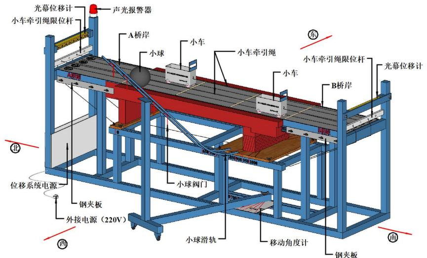
图 1 加载装置与模型轴测示意图
