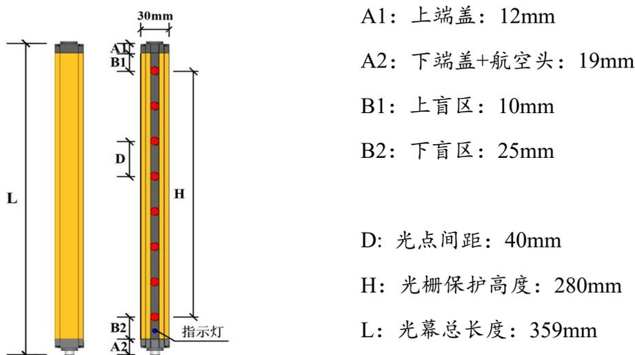
图9 光幕位移计示意图
